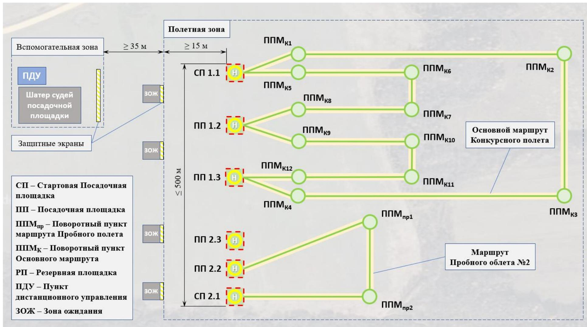
Принципиальная схема Посадочной площадки (ПП) с размещением основных элементов
