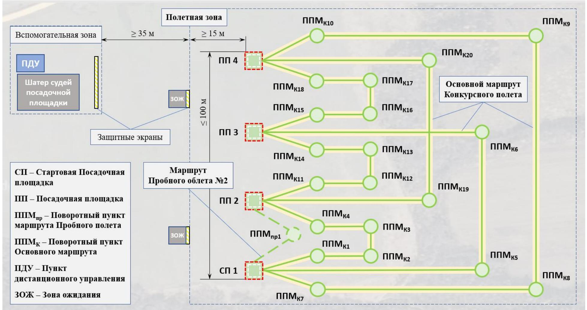
**Принципиальная схема Посадочной площадки (ПП) с размещением основных элементов**
